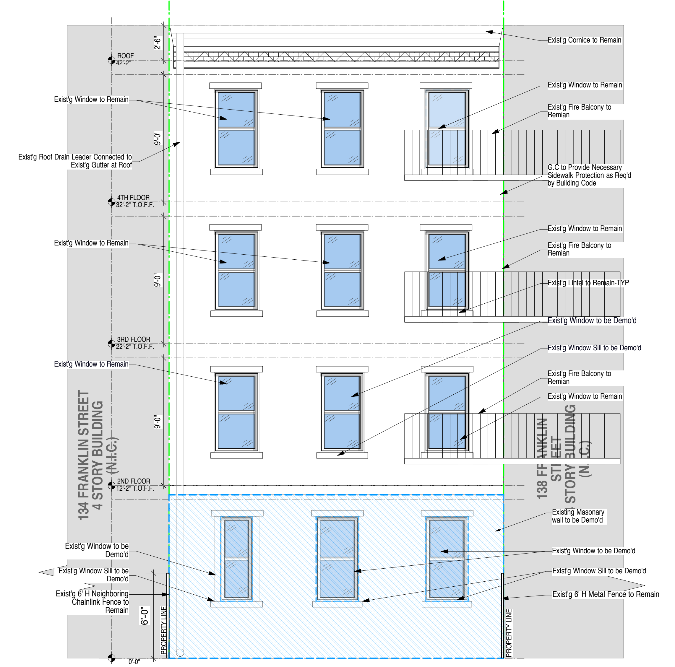
6 Demo/Existing Rear Elevation T-009.00 Scale: 3/8" = 1'-0"
