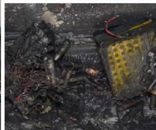
Des batteries endommagées ou instables et une charge, un stockage ou une mise au rebut inappropriés peuvent provoquer une surchauffe des batteries, entraînant un feu explosif et agressif qui se propage rapidement, peut se rallumer et est difficile à éteindre.
